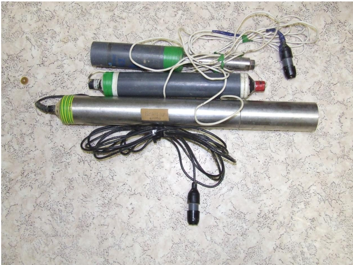
4. fotó: 1 és 3 csatornás Dataqua radonmonitorok
